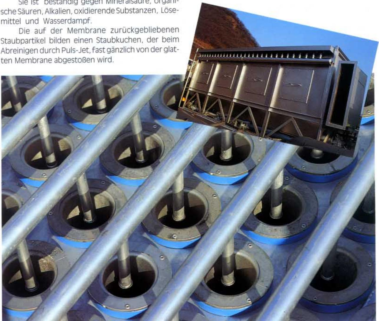
Gewebefilter mit Reinigungsdüsen
