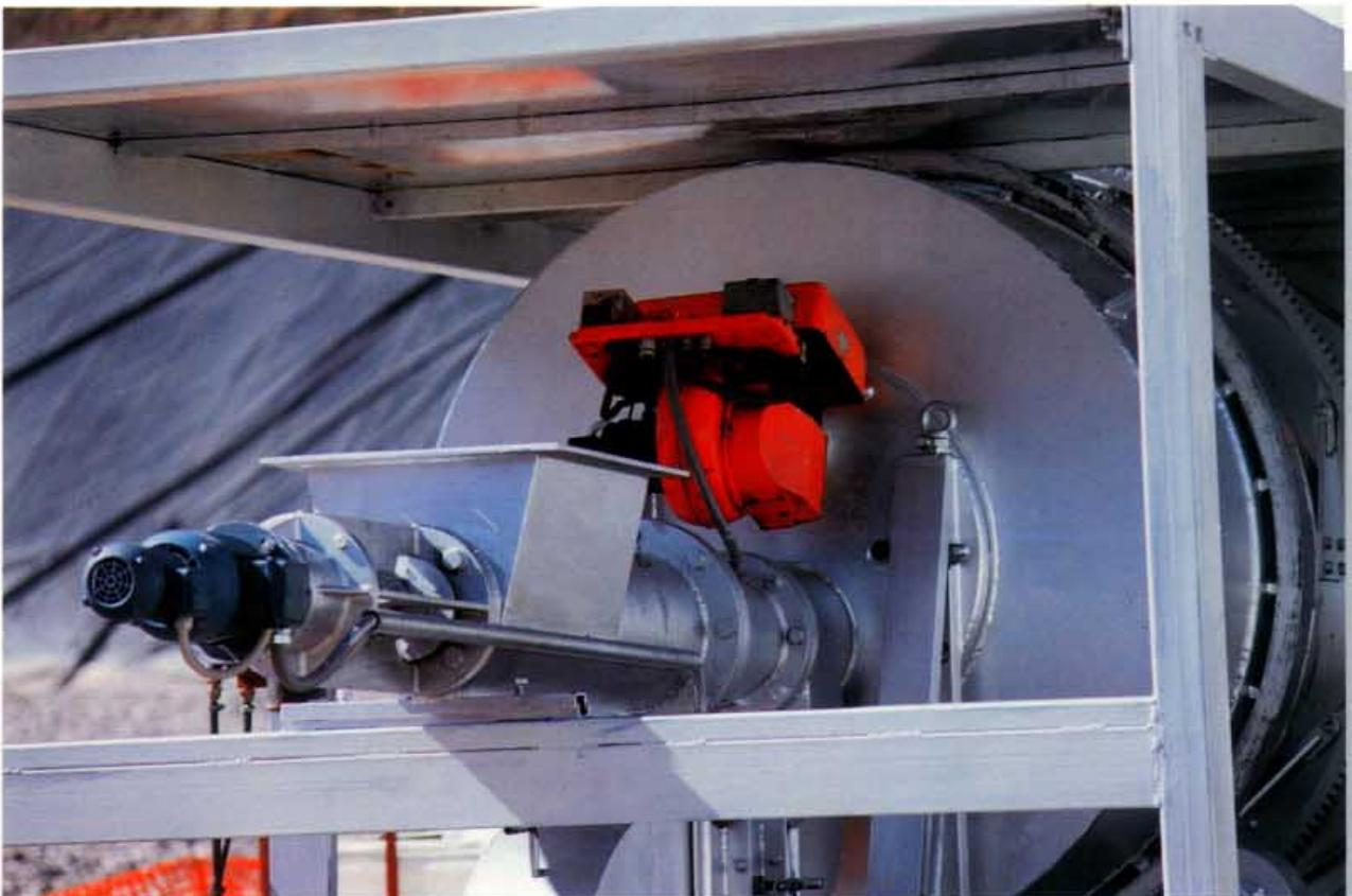
Stirnseite des Drehrohrrofens mit Beschickungsschnecke und Stützbrenner
